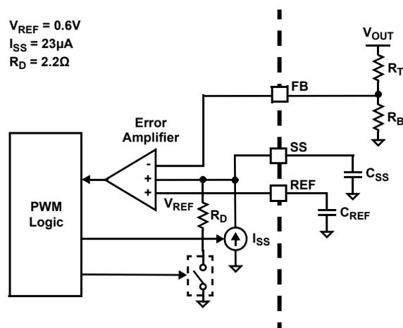
Figure 27. Soft-Start Circuit
